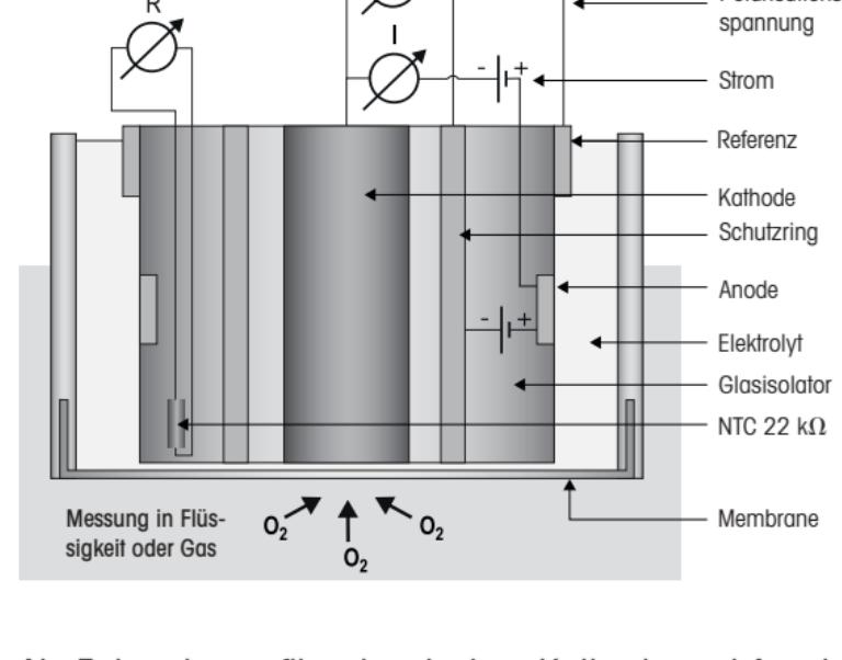
Als Folge davon fliesst zwischen Kathode und Anode ein Strom (4 Elektronen pro O<sub>2</sub>-Molekül), der proportional zum O<sub>2</sub>-Partialdruck an der Kathode ist.
