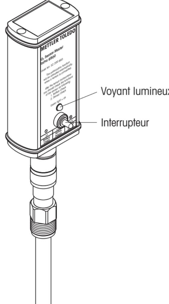
La fonction de polarisation est activée dès la connexion de la sonde au O<sub>2</sub> Sensor-Master. Si la sonde a été débranchée du transmetteur pendant plus de 5 minutes, polarisez la sonde (temps de polarisation, voir « Chapitre 5.1 ») afin d'obtenir des résultats de test représentatifs.
