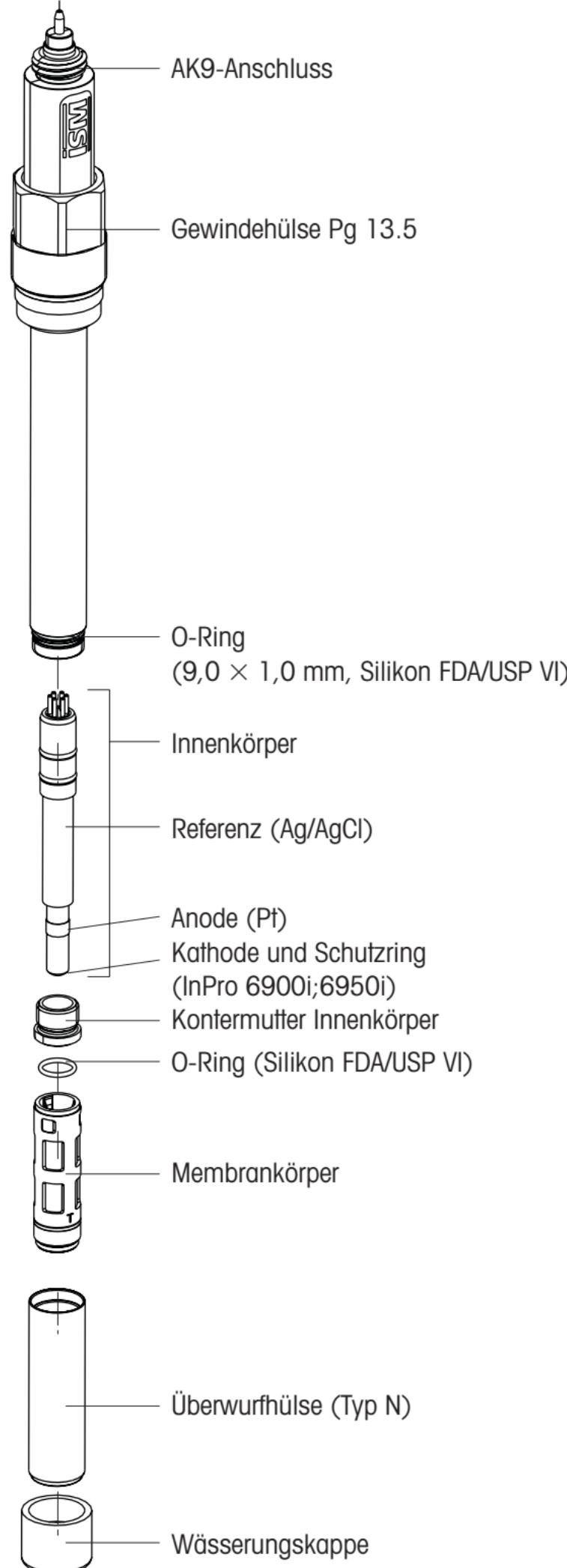
METTLER TOLEDO ISM O<sub>2</sub>-Sensoren werden mit montiertem Membrankörper, ohne Elektrolyt und mit aufgesteckter Schutzkappe ausgeliefert und sind auf einwandfreie Funktionsweise geprüft.
