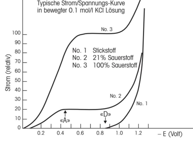
Die Polarisationsspannung sollte so konstant wie möglich sein. Neben einer konstanten Spannungsquelle müssen folgende Voraussetzungen erfüllt werden: Der elektrische Widerstand des Elektrolytfilms darf einen spezifischen Wert nicht überschreiten, damit ein Spannungsabfall verhindert wird.
