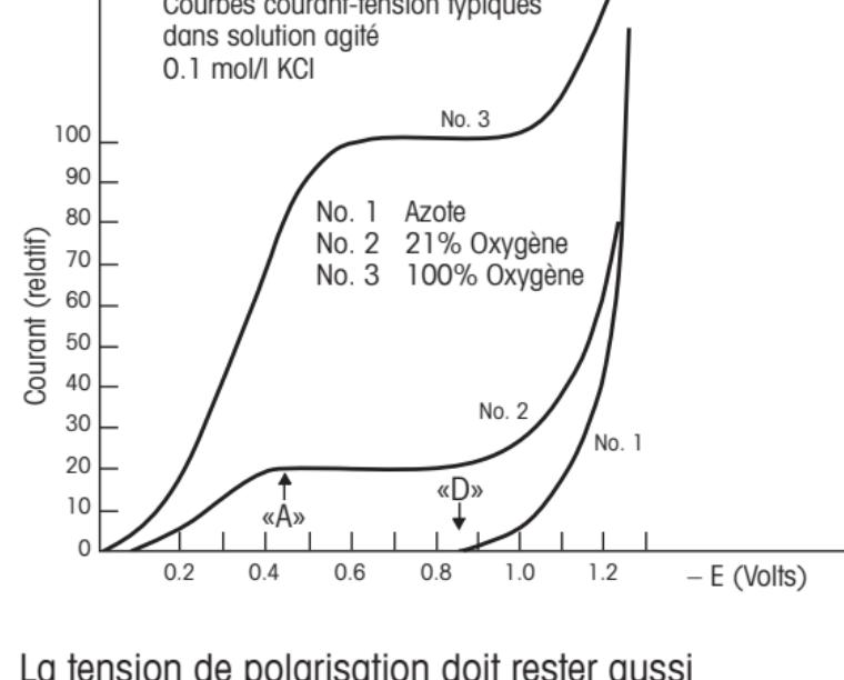
La tension de polarisation doit rester aussi constante que possible. Outre une source de tension constante, les conditions suivantes doivent éga-
